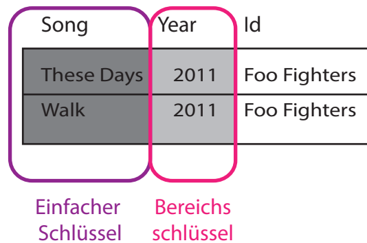
Abbildung 2.9: Darstellung zeigt einen Global Secondary Index in DynamoDB.
